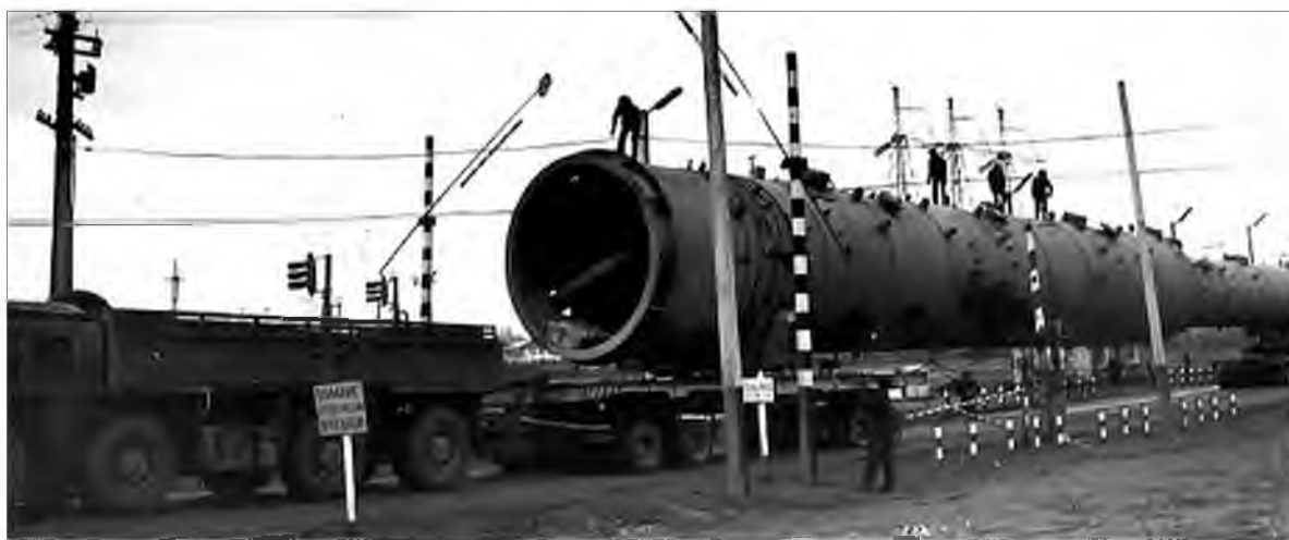
Абсорбер фирмы «Кемико» переправляют через железнодорожный переезд
